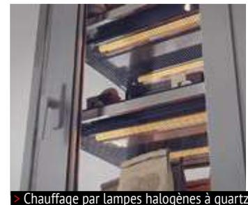
> Chauffage par lampes halogènes à quartz
