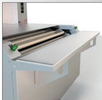
Tablette de boulage en inox rabattable avec tapis en polyuréthane alimentaire, démontable et lavable.
