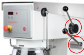
VL-1 – Régulation de la vitesse manuelle et abaissement manuel de la cuve
