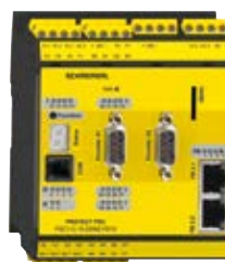
Avec surveillance sûre intégrée des entraînements (SDM – Safe Drive Monitoring) pour 1 entraînement
