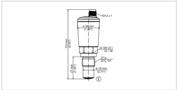
VEGAPOINT 24, version standard - Filetage avec connecteur M12 x 1
