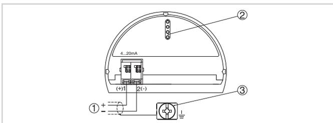
Compartiment électronique et de raccordement boîtier à chambre unique
