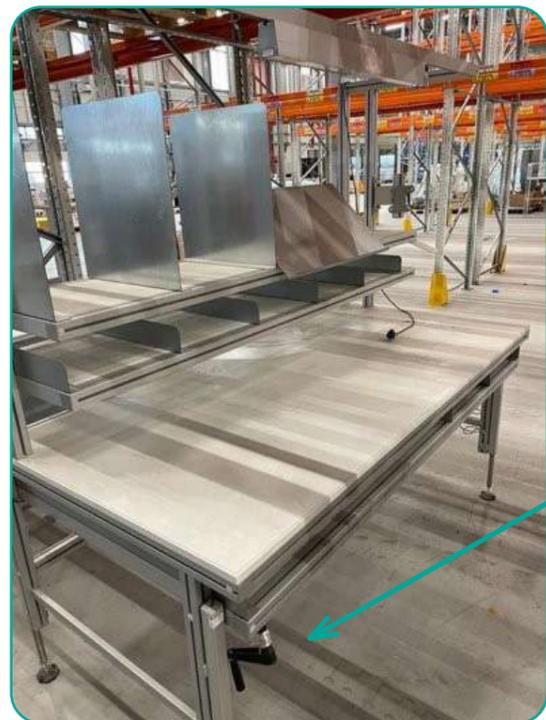
4 pieds hydrauliques télescopiques avec commande manuelle
