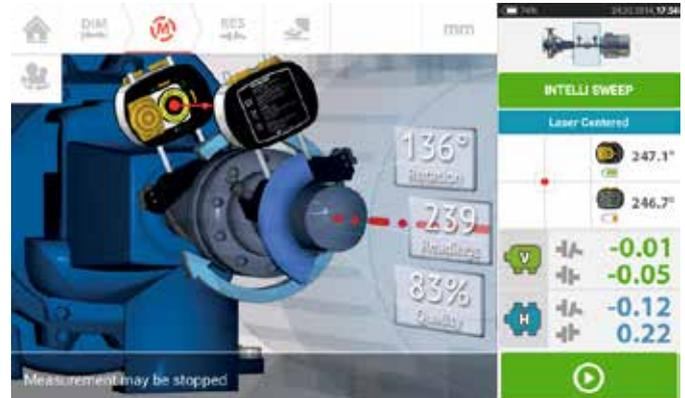
L'interface utilisateur intuitive accompagne l'utilisateur du début de la tâche à l'étape des résultats. En temps réel, l'utilisateur peut surveiller le processus IntelliSWEEP®, la qualité de la mesure et les positions physiques dans les sens horizontal et vertical de la machine pendant l'ensemble du processus d'alignement.
