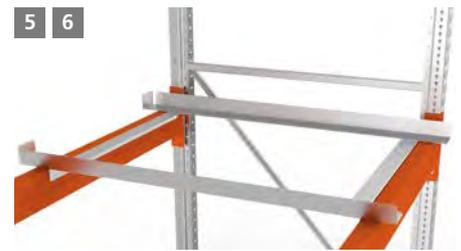
**!** \* La butée arrière du cadre ne doit pas être utilisée comme arrêtoir.
