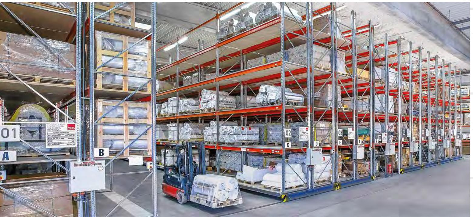
Les systèmes de rayonnages mobiles META MULTIBLOC sont disponibles en version avec **moteur électrique** pour les rayonnages à palettes (META MULTIPAL) ainsi que les rayonnages cantilever META MULTISTRONG HEAVY. Possibilité de rétrofit des rayonnages existants et de combinaison avec des rayonnages statiques. Avec le **rayonnage mobile META MULTIBLOC**, transformez les allées de circulation de vos entrepôts en **surface de stockage**.
