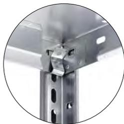
*Les tablettes sont accrochées à l'échelle à l'aide de crochets et sont à tout moment rapidement réglables en hauteur au pas de 25 mm afin de s'adapter à de nouveaux produits stockés*
