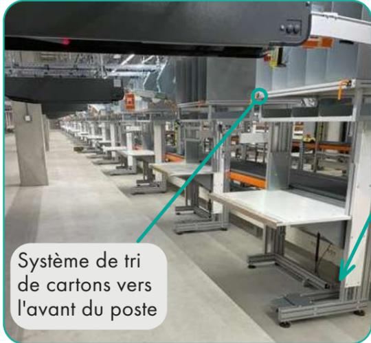
Système de tri de cartons vers l'avant du poste
