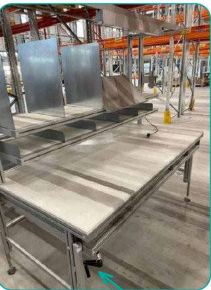
4 pieds hydrauliques télescopiques avec commande manuelle
