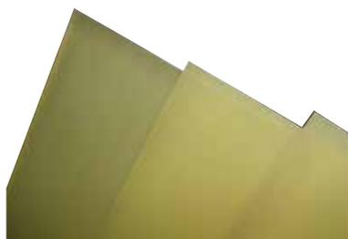
La référence Vetronit G11 est un stratifié constitué de tissu de verre et de résine époxyde de classe H/180°C. Le G11 a une haute résistance mécanique, notamment à haute température ainsi que des bonnes propriétés électriques.
