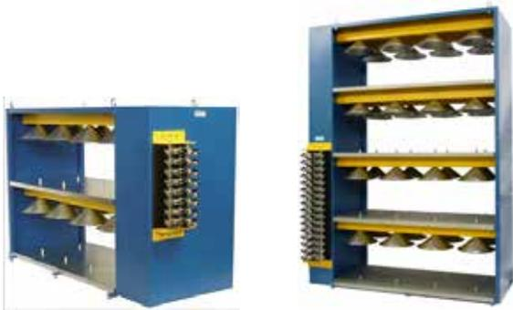
Les armoires métalliques à bobines permettent de stocker et ranger les bobines de fils de cuivre tout en disposant du fil sans avoir à les manutentionner à nouveau. Il existe plusieurs modèles selon la quantité et le type de bobines à stocker.
