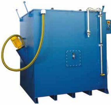
Les stands d'imprégnation que nous proposons ont été conçus pour les ateliers de réparations de moteurs et machines tournantes. Ces systèmes sont simples et ne nécessitent aucune maintenance. Le couvercle permet de protéger le vernis lorsque que le stand n'est pas utilisé
