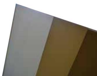
La référence Vetronit FR-4 ou EGS 619 est un stratifié fabriqué à partir de résine époxyde et de tissu de verre. Ce stratifié est adapté pour des applications avec des exigences mécaniques et électriques élevées. Il est homologué UL94 V0. Indice thermique B/130°C
