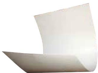
Cet isolant souple livré sous forme de plaque est à base de mat de verre polyester et chargée en résine. Il peut être enroulé sans détériorer ses caractéristiques techniques, son rayon de courbure minimum est de 20 mm.
