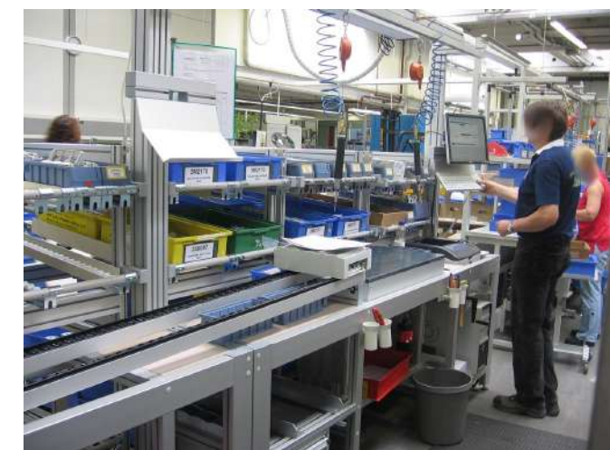
N10E038 NORCAN Ligne d'assemblage et d'emballage de boîtiers électriques équipée de systèmes de réglages de hauteur ainsi que de chariots avec poignées d'indexages et panneau en PEH.
