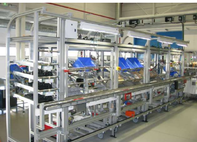
N08W077 NORCAN Ligne d'assemblage avec convoyeurs.
