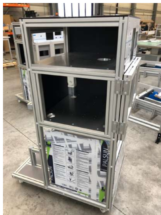
PR1911712 NORCAN Bâtis laser de marquage Hébergement d'une machine de gravure - Intégration de vitres
