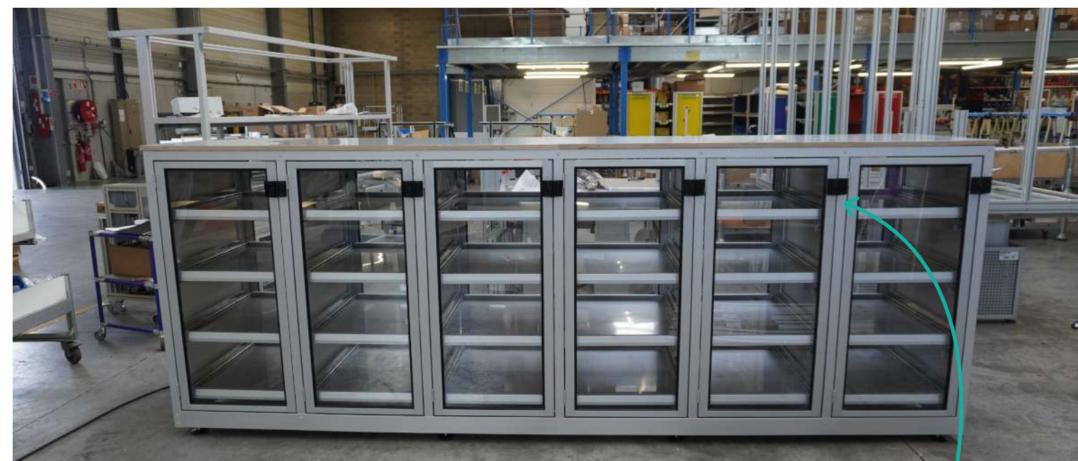
PR2403878 NORCAN Meuble de stockage comprenant 24 tiroirs Les tiroirs s'ouvrent vers l'avant et vers l'arrière. Chaque tiroir permet une charge de 250 kg.
