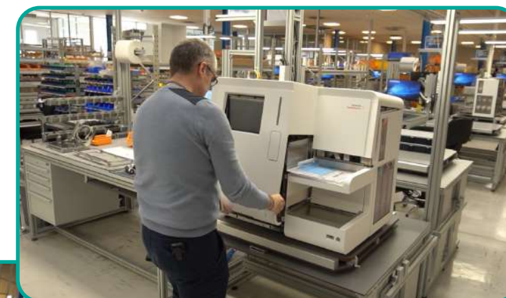
Règlage de la hauteur de l'espace de travail afin de faciliter les interventions
