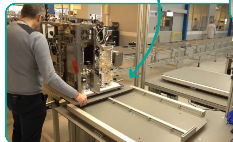
Règlage de la hauteur de l'espace de travail afin de faciliter les interventions
