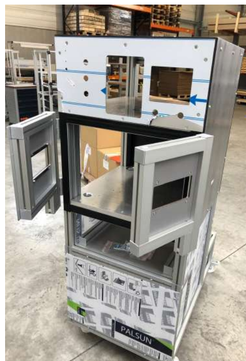
PR1911712 NORCAN Bâtis laser de marquage Hébergement d'une machine de gravure - Intégration de vitres
