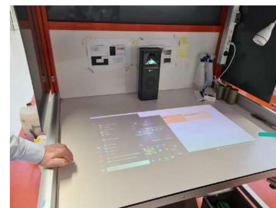
PR2205388 NORCAN Industrie textile Poste de découpe de patrons pour polos Système de projection ADOK, avec retour tactile
