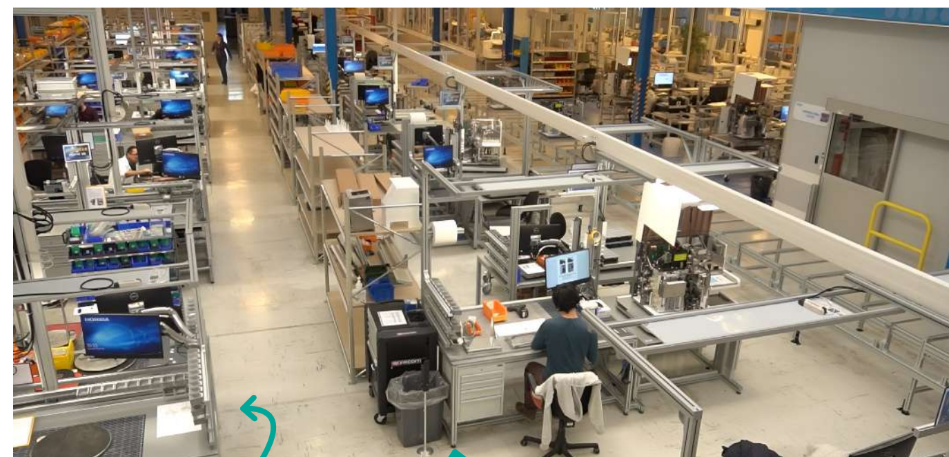
Postes ergonomiques de préparation de sous-ensembles
