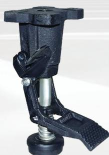
Patin d'immobilisation à fixation horizontale, destiné à être boulonné en dessous d'un châssis. De conception robuste, en fonte et en acier. Lors du positionnement, il faut conserver une garde au sol Z mm sous le patin caoutchouc en position relevée. Le blocage et le déblocage sont commandés par deux pédales indépendantes. Le patin AA89000 est équipé d'une double pédale de déblocage.
