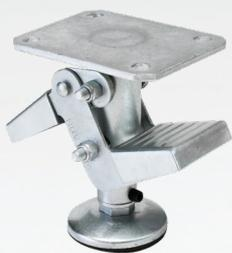
Patin d'immobilisation à fixation horizontale, destiné à être boulonné en dessous d'un châssis. De conception en tube et en acier. Lors du positionnement, il faut conserver une garde au sol Z mm sous le patin caoutchouc en position relevée. Le blocage et le déblocage sont commandés par deux pédales indépendantes.
