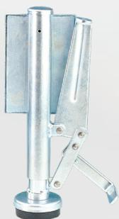
Patin d'immobilisation à fixation verticale, destiné à être boulonné ou soudé sur les côtés ou extrémités du châssis. De conception en tube et tôle d'acier emboutie. Lors du positionnement, il faut conserver une garde au sol Z mm sous le patin caoutchouc en position relevée. Le blocage et le déblocage sont commandés par deux pédales indépendantes. Ces patins se livrent le plus souvent par paire, un gauche TLCM-G et un droit TLCM-D.
