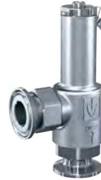
Les soupapes de décharge et de régulation des séries 417 et 418 conviennent à la protection des pompes. En outre, ces vannes sont optimales pour la décharge de pression et la régulation de réservoirs et de citernes (par ex. superposition de CO<sub>2</sub>) et optimales pour la décharge de pression de systèmes de tuyauterie fermés. En effet, le fluide qui s'échappe peut être évacué ou ramené de manière contrôlée.
