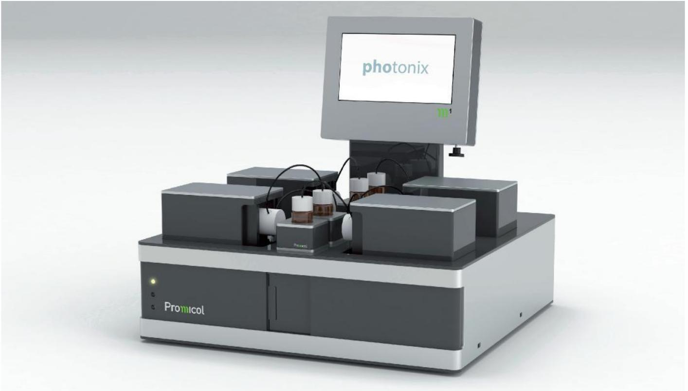
Luminomètre de paillasse pour tubes, compact, contrôlé par PC
