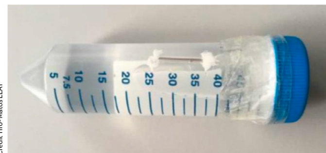
Figure 1 : Fantôme mimant les caractéristiques d'un corps de souris dans lequel a été fixé la puce RFID.
