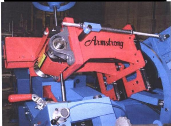
Ce nouveau kit de mise à niveau est livré complet avec les pièces nécessaires pour remplacer les points de la tête porte-meule, les vis de cône, les carters, la visserie de montage et le raccordement à la n° 4 ou la VariSharp
