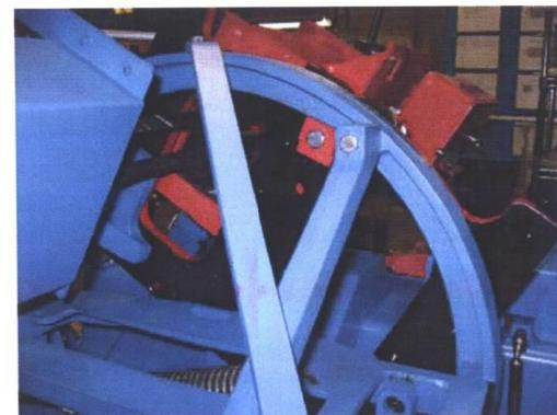
Enlever la tête porte-meule d'origine et le chariot et les remplacer par le kit, boulonner sur le système de tension de courroie et installer les carters.
