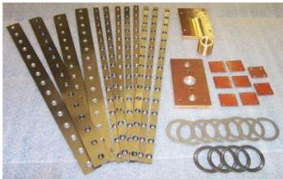
**Le tendeur Super Duty** est équipé de lames d'usure en acier durci et des sabots remplaçables en micarta sur les logements des roulements. Les rondelles nylon qui centrent les galets entre les blocs de roulement sur les machines Standard Duty sont remplacées par des butées à billes sur le modèle Super Duty.
