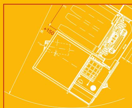
La longueur de sortie du mât (dimension X) a été augmentée pour atteindre 150 mm, sans modifier des dimensions du chariot. La portée supplémentaire offre des avantages opérationnels, avec une flexibilité accrue pour le chargement et le déchargement, et l'utilisation d'un plateau de 1 200 mm dans des circonstances qui nécessiteraient autrement un plateau de 1 400 mm, ce qui améliore la capacité de stockage.
