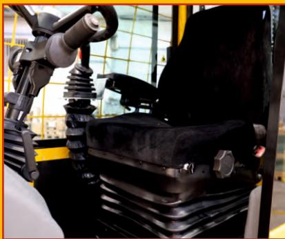
La cabine de l'opérateur entièrement repensée est au cœur de l'EXL, conçue pour transformer le confort et la facilité d'utilisation. 20 % plus grande que le modèle ELX, avec une largeur de 800 mm, une longueur supplémentaire de 200 mm et une hauteur accrue de 100 mm, elle permet d'accueillir un siège ergonomique plus spacieux, d'augmenter l'espace pour les jambes et les mouvements des bras, et d'offrir une toute nouvelle disposition du tableau de bord pour un contrôle et une visibilité optimale.
