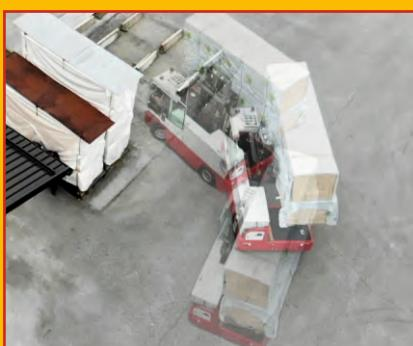
Une longueur réduite et le rayon de braquage optimisé ont été obtenus sans changer la largeur du mât, du châssis, ainsi que la garde au sol ou la faible hauteur du plateau.
