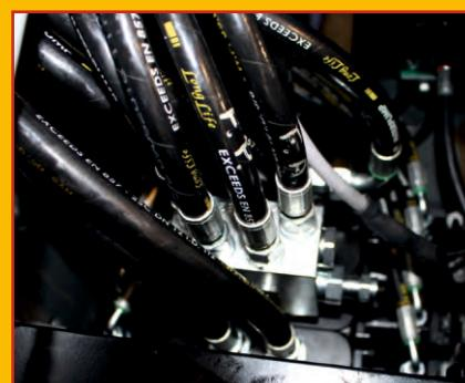
L'EXL utilise un essieu directeur sur mesure et un système hydraulique à débit adapté. Grâce à un contrôle en boucle fermée, la pression hydraulique est ajustée en fonction de la charge, ce qui permet d'économiser de l'énergie et d'améliorer l'efficacité.
