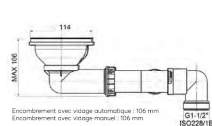
Encombrement avec vidage automatique : 106 mm
