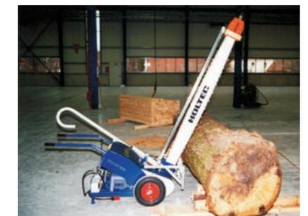
Convient également pour couper des grumes, des bobines de papier, des tubes PVC etc.
