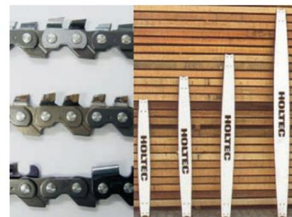
Ensemble de coupe avec guide-chaîne stellité des 2 côtés - réversible 4 fois (longueur de coupe 100 à 250 cm). Livrable avec chaîne STIHL à dents pointues, à pastilles de carbure WIDIA ou à gouges
