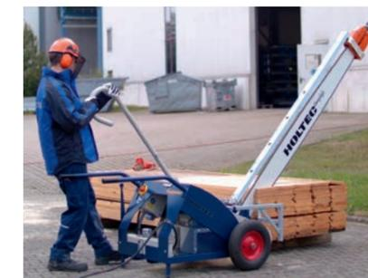
Maniement facile et effort de coupe réduit. Roues à pneus et triple butée d'alignement garantissant une position précise et une coupe à angle droits
