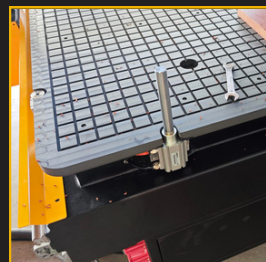
Butées pneumatiques de positionnement
