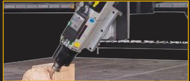
Tête 4 axes sur broche pour usinage sur les chants et création de hauts reliefs
