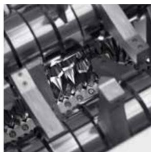
Grâce aux rotors innovants du VPC 1600, le bois est préconcassé, avant d'être affiné par les couronnes de coupe du rotor VHZ.
