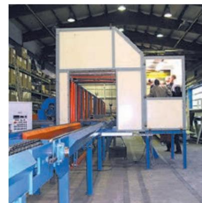
Cabine de commandes et carénage de la machine
