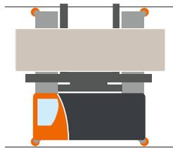
Galets de guidage entre rails (100 mm de distance de sécurité par côté) jusqu'à 4,5 t en version simple et à partir de 4,5 t en version double. Ce guidage mécanique est robuste et son utilisation a fait ses preuves.
