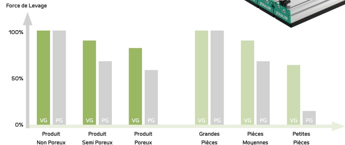
Avec une faible surface de préhension, la technologie VG est mieux adaptée car il n'y a pas de fuites là où le préhenseur n'est pas couvert. Les clapets ou les trous calibrés sont réglables afin d'obtenir différentes sensibilités.
