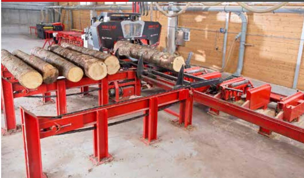
C'est une combinaison de scies à ruban et de scies circulaires sélectionnées visant à maximiser l'efficacité des produits finis dans un espace réduit.
