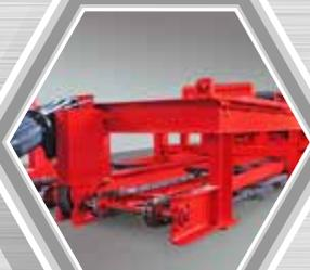
Tapis robuste et surélevé avec convoyeur automatique de sciure et résidus
