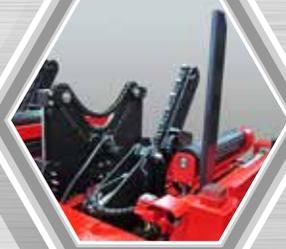
Équipement de manipulation des grumes le plus récent : tourneurs coulissants, tourneurs d'agrumes et prismes rapides brevetés, levage hydraulique à deux niveaux des cales
