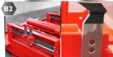
pince à double cylindre + Levage mécanique des cales
