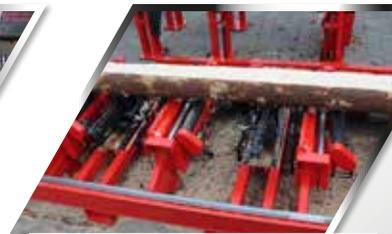
structure robuste et solide du tapis, en matériaux optimisés, tourneurs coulissant verticalement et horizontalement
