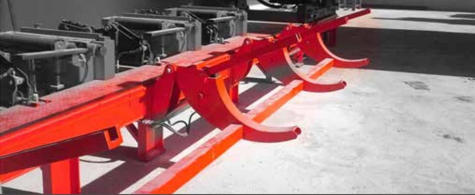
Les bras autochargeurs sont recommandés pour les scies à ruban de taille petite et moyenne avec une faible capacité de grumes.
