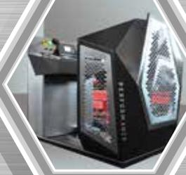
Panneau de commande autonome séparé avec siège et deux leviers de commande multifonctions
