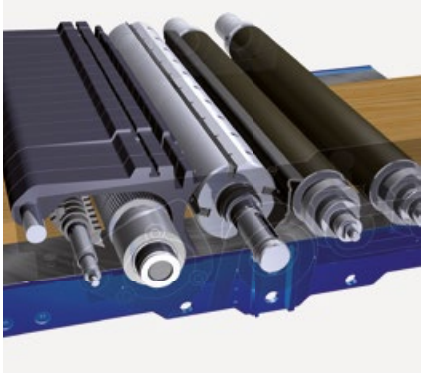
Surfaces usinées d'excellente qualité Grâce aux barres de pression segmentées et aux rouleaux entraîneurs de sortie gommés
