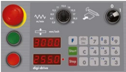
« Digi-Drive » Commande programmable de la table de rabot
