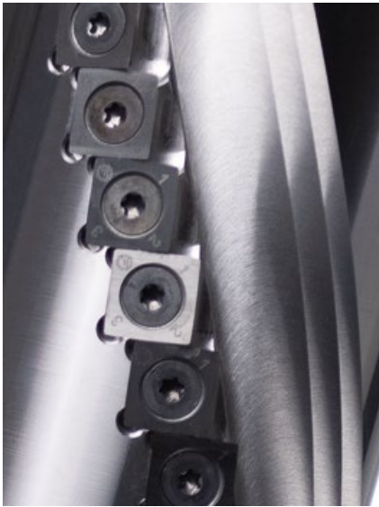
Arbre rabot-dégau hélicoïdal Silent-Power® Réduction de moitié du volume sonore
