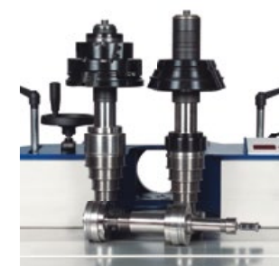
Système de changement rapide de l'arbre de toupie
