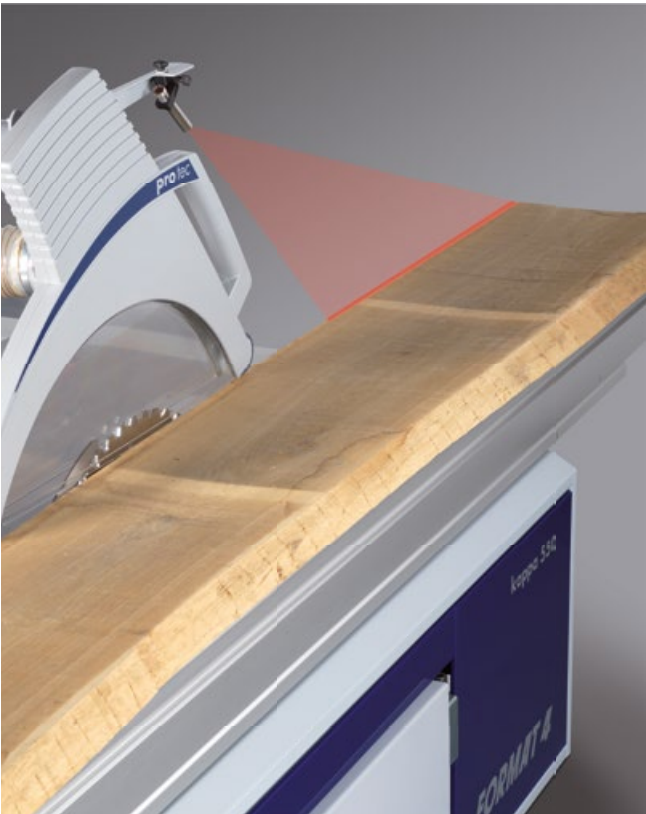
Visualisation du trait de scie par rayon laser
