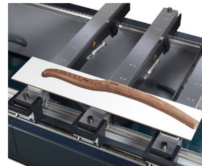
Travaux de fraisage de gabarits
