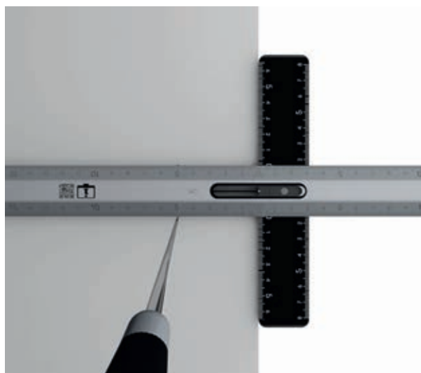
TRACÉ D'UNE TRAME POUR LA SÉRIE 32 DIBUJE UNA CUADRÍCULA DE 32 MM
