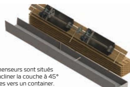
D. Variante de la version C. Les préhenseurs sont situés entre les baguettes et peuvent incliner la couche à 45° afin de laisser glisser les baguettes vers un container.
