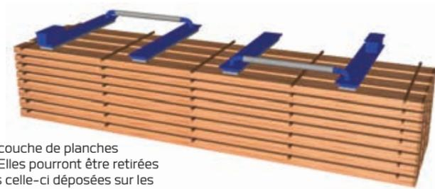
C. Le dépileur aspire la couche de planches entre les baguettes. Elles pourront être retirées de la couche une fois celle-ci déposées sur les chaînes d'alimentation.
