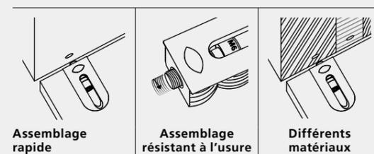
Cabineo 8 M6 est un élément d'assemblage de meuble monobloc pouvant être utilisé avec toutes les machines CNC, car seule la surface est usinée. Il est idéal pour l'assemblage de bois, panneau avec des matériaux tels que l'aluminium, l'acier ou le HPL.
