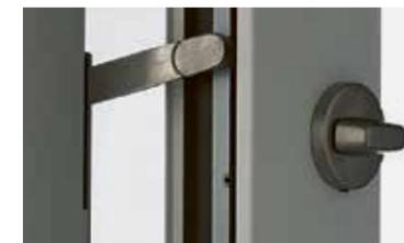
L'**entrebâilleur TSH** permet de limiter l'ouverture de la porte. Le déverrouillage depuis l'extérieur s'effectue par la serrure principale (pas de cylindre à l'extérieur). Un bouton rotatif permet de l'actionner depuis l'intérieur.
