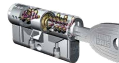
Le **cylindre à billes** est doté d'un système de sécurité à balayage et perçage breveté tridimensionnel ainsi que d'un système anti-arrachement. La forme spéciale de la clé permet un verrouillage facile et empêche la flexion et la rupture de la clé. Il est verrouillable des 2 côtés. La clé réversible symétrique s'insère très facilement dans le cylindre.
