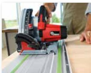
La MT 55 cc se laisse aussi utiliser avec d'autres systèmes de règles de guidage.
