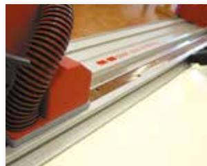
La quasi totalité des particules de poussières est aspirée grâce au revêtement intégral de la lame de scie, au canal d'aspiration intégré sur toute la longueur de la machine et l'aspirateur MAFELL S 50 M.
