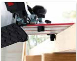
La goupille d'arrêt fixe et la butée réglable permettent que le système puisse être utilisé pour des coupes d'angle de +50° à -60°.
