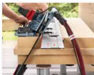
La DSS 300 cc peut être réglée en continu jusqu'à 60° à l'aide de la graduation afin d'obtenir des coupes inclinées exactes. La coupe peut être réalisée ensuite avec un appui supplémentaire sur ou à côté de la règle de guidage.
