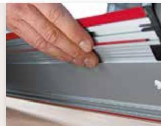
Pour une précision et une découpe optimales – la règle de guidage avec pare-éclats.
