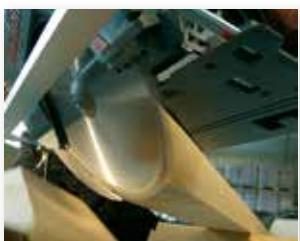
Idéale pour les coupes d'empanoir: la MKS 130 Ec peut être inclinée jusqu'à 60°. La profondeur de coupe maximale s'élève dans ce cas à 65 mm, ce qui est considérable.
