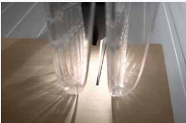
L'éclairage de travail assure la meilleure visibilité possible de la coupe. Le capot protecteur partiellement transparent recouvre complètement la lame de scie et garantit ainsi un surplus de sécurité.
