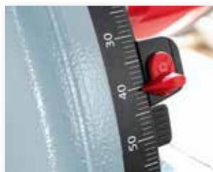
Avec ou sans règle de guidage – la bonne profondeur de coupe sera toujours visible en tournant simplement l'indicateur de coupe.
