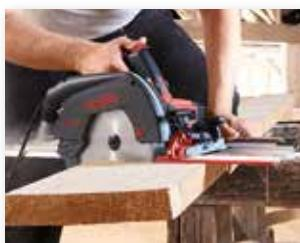
Tout-en-un : sur la scie à règle de guidage, la machine et la règle de guidage sont solidaires.
