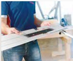
La butée angulaire peut être reliée à toutes les règles de guidage F grâce à sa pièce de raccordement. Installez la pièce sans peine, faites glisser, serrez. C'est terminé.
