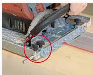
Compensation parfaite de la hauteur. L'épaisseur du matériau du guidage de chaîne est compensée par l'élément en Pertinax.
