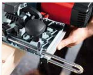
Le nouveau guide par retournement permet une grande précision même dans des coupes délicates. Les dimensions se règlent exactement avec deux graduations sur les étriers.
