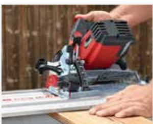
Grâce à la graduation angulaire de grande dimension et au double serrage précis, des coupes en onglet parfaitement ajustées peuvent être réalisées.
