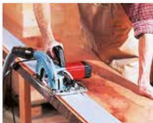
Coupes précises grâce à la MS 55 et le système de règles de guidage.
