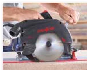
Le couteau diviseur FLIPPKEIL permet une coupe plongeante sûre, simple et aisée sans qu'il soit nécessaire de le dévisser.
