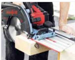
La butée angulaire se fixe sans problème à la règle de guidage. Placer l'adaptateur, faire glisser, bloquer et régler le nombre de degrés. La pièce peut alors être coupée avec précision suivant l'angle souhaité.
