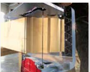
Grâce aux couples de rotation élevés, le Z 5 Ec ne rencontre pas la moindre difficulté dans le bois massif avec une profondeur de coupe de 305 mm.
