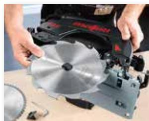
Le changement de lame est rapide, sûr et aisés. Poussez le bouton de déverrouillage et relever le capot pivotant dans le carter, desserrer la bride, retirer la lame, placer une nouvelle lame et la serrer.
