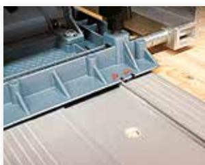
La ZSX-TWIN Ec peut être montée sur le système de guidage F MAFELL déjà en place, pour un guidage de coupe d'une grande précision.
