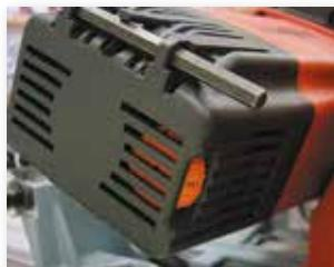
Roue de réglage permettant de régler la vitesse selon les différents matériaux.
