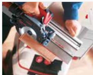
Vous obtenez un système extrêmement fonctionnel à une main grâce au raccord fix entre la scie circulaire portative et la règle de mise à longueur.
