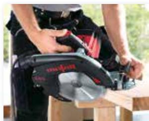
Le capot pivotant est relevé simplement et aisément avec la seconde poignée. Ainsi, le positionnement de la machine est sûr et aisés, notamment pour des coupes en biais.
