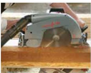
La MKS 130 Ec, combinée avec l'aspirateur S 50 M et avec la règle de guidage, permet partout des coupes propres et précises, même dans les matériaux isolants difficiles.
