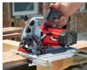
Avec les règles de guidage MAFELL ou le guide parallèle fourni avec la scie et muni d'une graduation millimétrique, des sols de terrasse, par exemple, peuvent être ajustés avec précision.
