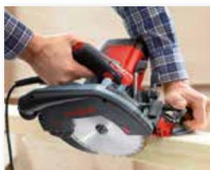
Le capot pivotant, actionné aisément et simplement avec le releveur, assure le confort et la sécurité lors de coupes plongeantes et biaises.
