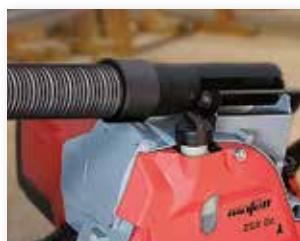
Avec une profondeur de coupe pouvant atteindre 400 mm, la quantité de copeaux produite est considérable. C'est la raison pour laquelle la ZSX-TWIN Ec peut aussi être utilisée avec un dispositif d'aspiration.
