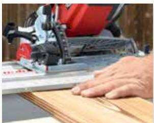
Grâce à la graduation angulaire de grande dimension, des coupes en onglet parfaitement ajustées peuvent être réalisées. Comme ici à l'exemple d'un bardage.
