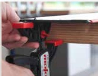
2 serre-joints permettent de fixer également la règle de guidage sur la pièce à travailler.
