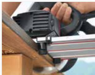
La goupille d'arrêt fixe et la butée réglable permettent des coupes d'angle de +60° à -60°.
