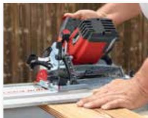
Grâce à la graduation angulaire de grande dimension, des coupes en onglet parfaitement ajustées peuvent être réalisées. Comme ici à l'exemple d'un bardage.
