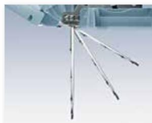
La plage de pivotement de 0° à 60° permet de réaliser des coupes à inclinaison extrême.
