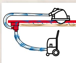
Aspiration lors de découpes de plaques, portes, etc. La pièce F-AFU 130 est aspirée par dessous grâce à l'adaptateur double et fixée à la règle de guidage d'une longueur de 1,3 m.
