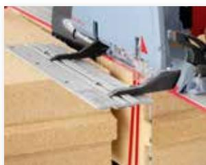
Grâce à la parfaite interaction de tous les composants du système et aux détails innovants, tels que câble de sciege, onglet de guidage en carbone et racleurs de copeaux, il est possible d'obtenir une qualité de coupe ultraprecise.
