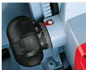
Une poignée précise facilite le réglage de la profondeur de coupe.
