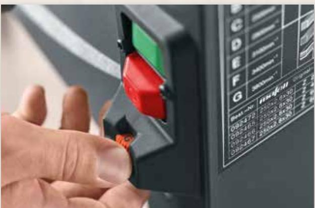
Le réglage progressif de vitesse, en fonction des besoins et utilisations individuels, est placé de manière idéale sur le panneau avant. Ceci permet de régler aisément la vitesse de rotation en fonction des divers matériaux et applications.
