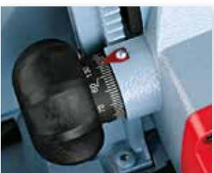
Une manivelle précise facilite le réglage de la profondeur de coupe.
