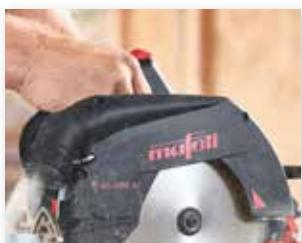
Le guide-copeaux a été conçu et optimisé pour la coupe de matériaux en fibres de bois. Le remarquable guide-copeaux présente également des avantages considérables lors de coupes plongeantes dans le sens des fibres.
