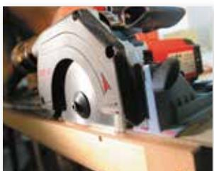
Maniabilité et guidage optimal de la règle. Deux garanties pour une grande précision, comme c'est le cas ici lors de la mise à longueur de portes de chambres.
