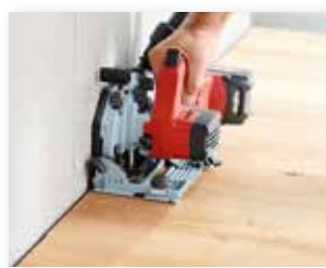
Finition parfaite: Les butées de protection de la scie circulaire portative permettent l'exécution facile d'arasements à partir d'une largeur de 13 mm.
