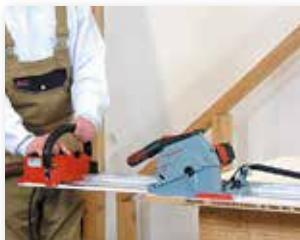
Le système de commande d'avance et recul automatique permet à une personne de découper les panneaux jusqu'à 3,10 m. Le module de réglage intégré permet d'avoir la vitesse appropriée à la matière usinée.
