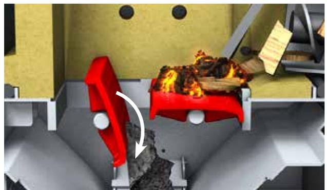
En fonctionnement, la chaudière effectue **des décentrages partiels** (seule la grille arrière pivote). Cela permet d'éliminer les cendres du foyer tout en conservant le lit de braise principal pour une combustion continue.
