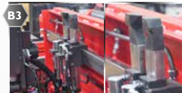
pince à double cylindre + levage hydraulique des cales
