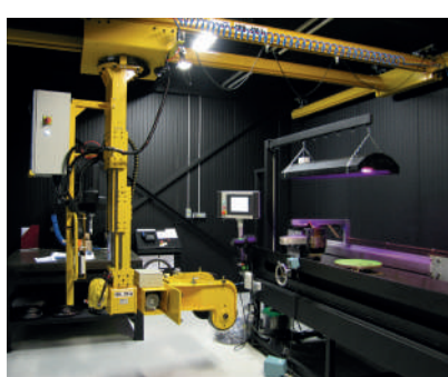
Colonne télescopique prise de pièces métalliques
