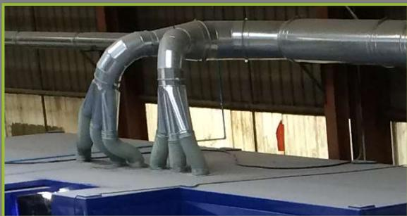
Avec sa configuration compacte du bâti et de son bac d'aspiration en partie haute la machine permet l'évacuation des micro-poussières ainsi que la diminution des émissions sonores.
