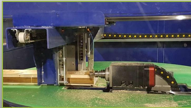
Les 2 presseurs inclus dans chaque pince, permettent de plaquer précisément le bois en référence avant l'usinage.
