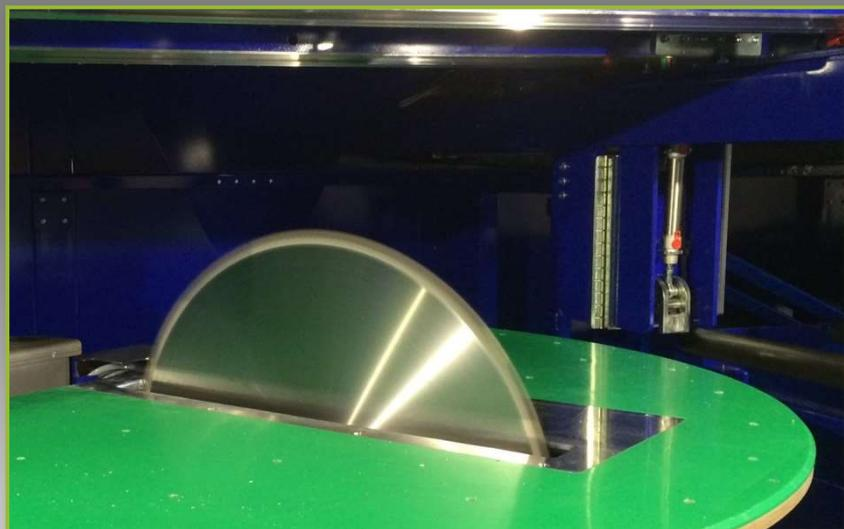
Scie sous table pour une coupe de précision avec orientation de  $0^\circ$  à  $360^\circ$  et inclinaison de  $30^\circ$  à  $150^\circ$ .
