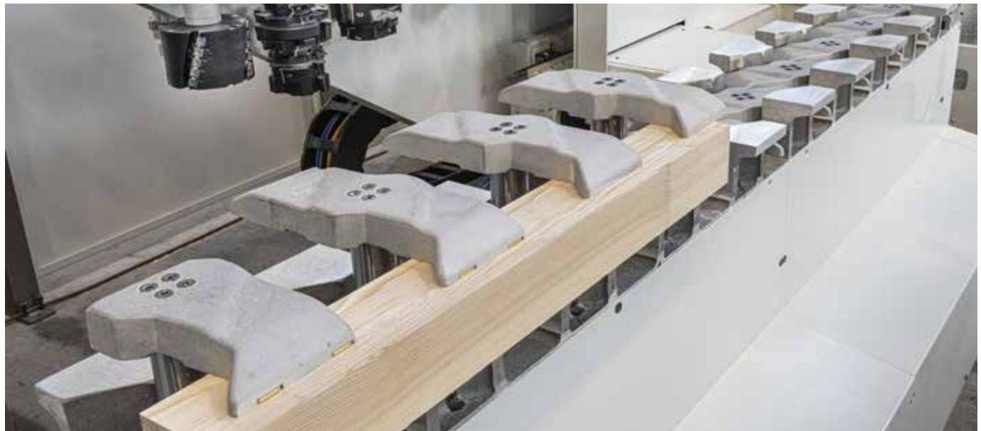
Perfekte Spannung des Werkstückes, unabhängig von dem Profil oder der Sektion. Gleichbleibende Genauigkeit. Maximale Flexibilität in der Produktion.
