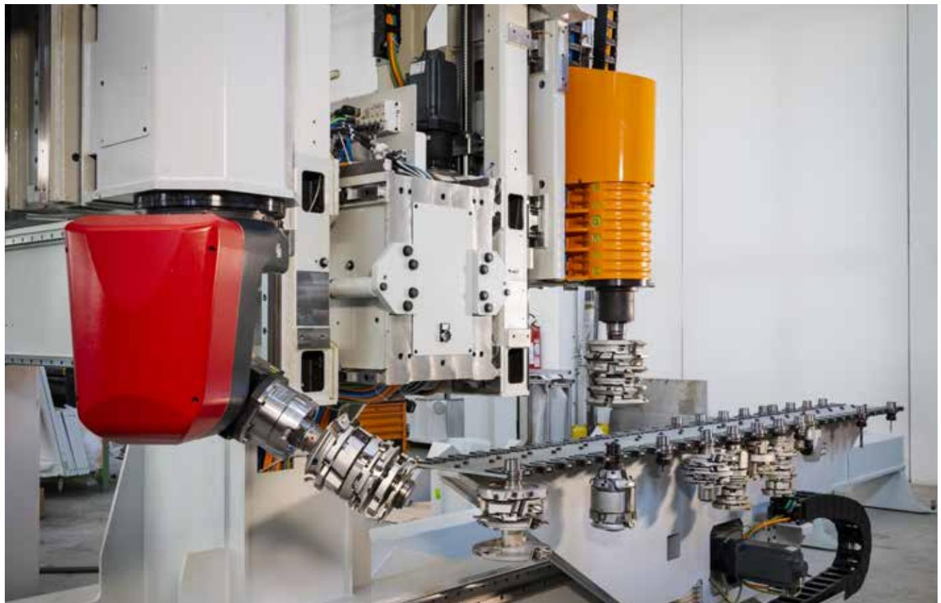
WOODPECKER MIRAI ist auf der rechten Seite mit einer 19 kW-Hauptelektrospindel und auf der linken Seite mit einem zweiten 15 kW-5-Achsen-Motor ausgestattet, um eine nahezu unbegrenzte Bearbeitungs- und Splitflexibilität zu gewährleisten: jedes Werkstück kann an allen sechs Seiten dreidimensional bearbeitet werden. Außerdem ist es mit spezifischen Satellitenmotoren für die obligatorische und sich wiederholende Bearbeitungen, die an jedem Werkstück stattfindet.
