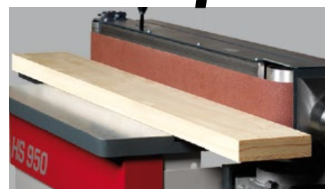
Construction ouverte pour un usage de pièces de longueurs illimitées
