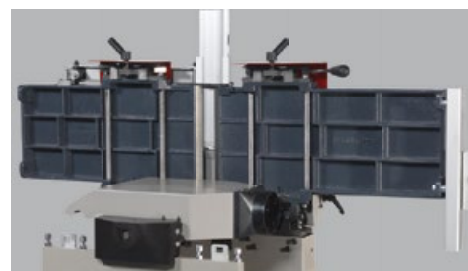
Les ouvertures doubles des tables de dégauchissage en position finale 0° économisent une place précieuse
