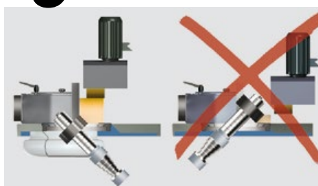
Inclinaison correcte de l'arbre de toupie vers l'arrière pour plus de sécurité
