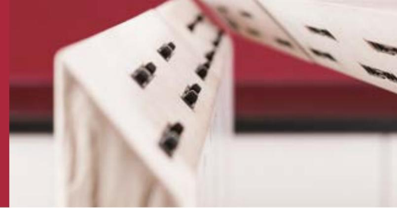
Pour pouvoir créer des **assemblages avec différents angles**, au moins une des deux pièces à usiner doit comporter un bord biseauté. Pour pouvoir fraiser une rainure dans ce bord, **deux solutions** sont possibles : placer la Zeta P2 sur le côté externe de la pièce à usiner, ou le placer sur le côté interne de la pièce.
