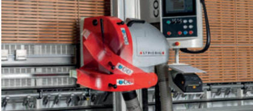
L'orientation automatique du moteur n'est qu'une des nombreuses fonctions qui contribuent au sciage entièrement automatique avec la CONTROL. Profondeur de coupe de série : 80 mm.
