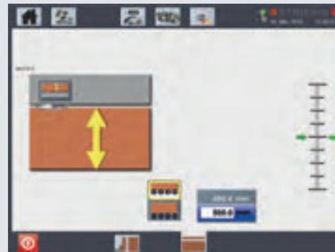
Ajustement précis automatique du groupe de sciage lors de la découpe horizontale à partir de l'appui de panneau et de la découpe de liteaux.
