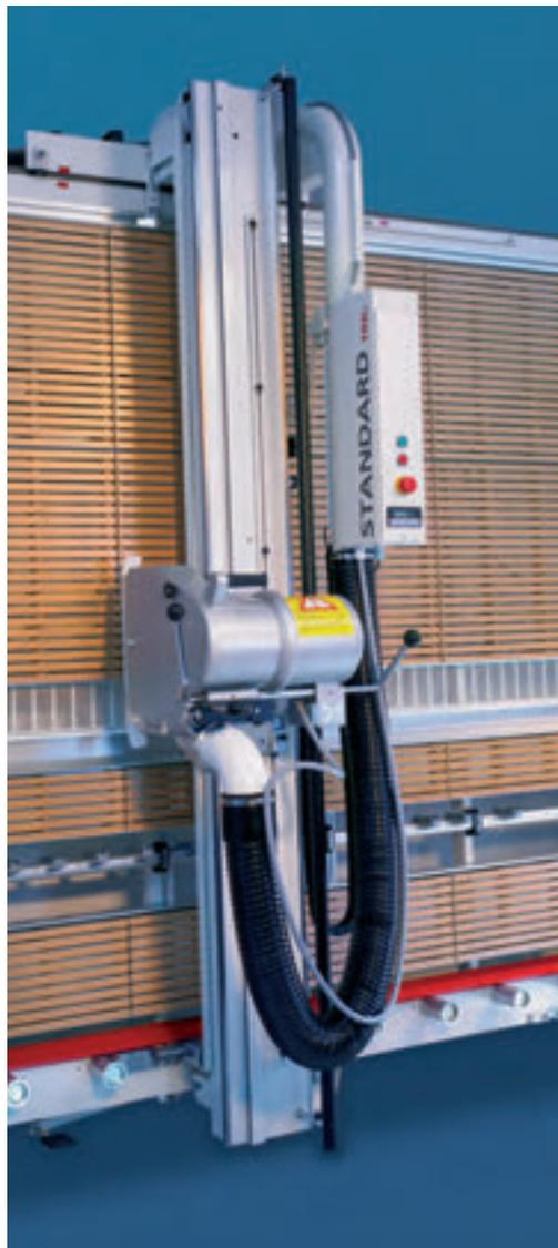
Fonctionnement ergonomique : pou-tre, boîtier de commande et moteur de sciage (5,5 kW) de la STANDARD.
