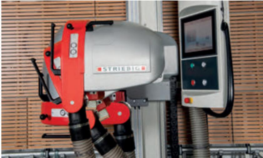
Simplification du travail pour l'opérateur : l'arrêt et le pivotement sont automatiques, tout comme, la plongée et le dégagement du groupe de sciage.
