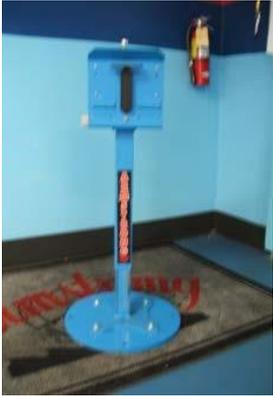
Ce nouveau support de poteau motorisé va monter et descendre avec le pied arrière pneumatique . Si besoin on peut en rajouter un en fonction de la taille de la scie.
