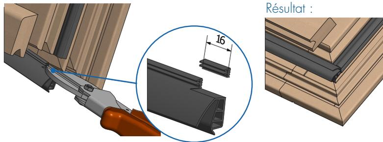
B. Coupe du joint de traverse basse sur le vantail semi-fixe
