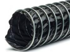
**Structure:** Gaine flexible très légère faite d'une paroi en tissu de verre enduit de Teflon électroconductive, renforcée d'un profil en acier galvanisé.
