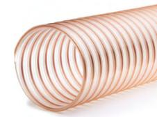
**Structure:** Gaine flexible faite d'une paroi polyuréthane polyéther souple de qualité alimentaire selon la norme 10/2011 modifiée et CE 1935/2004, renforcée d'une spirale en acier ressort cuivrée pour une mise à la terre. Surface intérieure très lisse. Sans halogènes et sans plastifiants.
