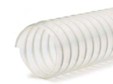
**Structure:** Gaine flexible faite d'une paroi polyuréthane polyéther classé feu selon la norme DIN 4102 / B1, TRBS 2153; renforcée d'une spirale en acier ressort cuivrée pour une mise à la terre.
