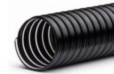
**Structure:** Gaine flexible, faite d'une paroi en PVC souple, renforcée d'une spirale en acier gainée PVC. Construction spéciale avec une paroi en « vague » pour une flexibilité optimale. Spirale d'acier de mise à la terre.
