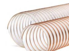
**Structure:** Gaine flexible faite d'une paroi polyuréthane polyéther souple, classée feu selon la norme DIN 4102 B 1 et antistatique permanent (R<10<sup>8</sup> Ohm) conforme TRGS 727 et ATEX 2014/34/EU; renforcée d'une spirale en acier cuivrée.
