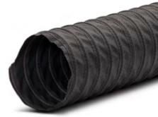
**Structure:** Gaine flexible de poids moyen faite d'une paroi en tissu de polyester enduit de PVC antistatique classée au feu suivant la norme M2, renforcée d'une spirale en acier pour une mise à la terre.
