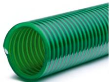
**Structure:** Tuyau flexible fait d'une paroi PVC très souple, résistant aux basses températures et aux UV, renforcé d'une spirale en PVC rigide de qualité antichoc.
