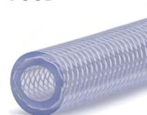
**Structure:** Tuyau flexible fait d'une paroi PVC souple sans phtalate de qualité alimentaire selon la norme 10/2011 modifiée (simulants A, B, C) et CE 1935/2004, renforcé de fils polyesters.
