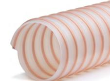
**Structure:** Gaine faite d'une paroi polyuréthane haute température souple, renforcée d'une spirale en acier ressort cuivrée pour une mise à la terre. Intérieur très lisse.
