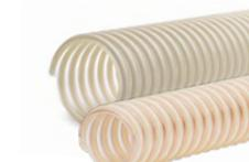
**Structure:** Gaine flexible faite d'une paroi polyuréthane polyéther souple de qualité alimentaire selon la norme 10/2011 modifiée et CE 1935/2004 (simulant A, B, C, D1, E), renforcée d'une spirale en PVC rigide antichoc. Version ANT munie d'une tresse cuivrée pour une mise à la terre. Résistante à l'hydrolyse et aux micro-organismes.
