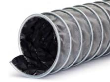
**Structure:** Gaine flexible légère faite d'une paroi en tissu polyester enduit d'Hypalon, et d'un film intérieur en Téflon, renforcée d'un profil en acier galvanisé.
