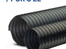
**Structure:** Gaine flexible faite d'une paroi polyuréthane polyester souple, renforcée d'une spirale en acier ressort cuivrée pour une mise à la terre. Très lisse intérieur. SERIE 5 PUR SX: Paroi 1,4mm, SERIE 5 PUR S2X: Paroi 2,0mm, SERIE 5 PUR S3X: Paroi 2,5mm.
