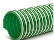
**Structure:** Tuyau flexible breveté sur le principe original d'une double spirale, comportant une spirale interne, utilisée comme support principal de la structure du tuyau, et une seconde spirale externe assurant une flexion sans pli et un renfort supplémentaire à la résistance du tuyau au vide.
