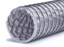
**Structure:** Gaine flexible légère faite d'une paroi en tissu de verre enduit de silicone, renforcée d'un profil en acier galvanisé. Classement feu M0 sur demande.
