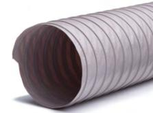
**Structure:** Gaine flexible très légère faite d'une paroi en tissu de verre enduit PVC classée au feu suivant la norme UL 94V0, renforcée d'une spirale en acier pour une mise à la terre.
