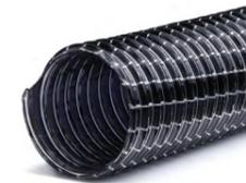
**Structure:** Gaine légère faite d'une paroi en PVC souple renforcée d'un quillage textile polyester et d'une spirale en acier gainée PVC. Spirale d'acier de mise à la terre. Grande résistance longitudinale à la traction.
