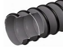
**Structure:** Gaine flexible cousue, construction et conception sur demande. Tissu de verre ou de polyester enduit néoprène, bonne résistance à la température, bande d'usure extérieure de protection.
