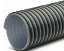
**Structure:** Tuyau flexible fait d'une paroi PVC extrêmement souple chargée Nitrile, renforcé d'une spirale en PVC rigide de qualité antichoc, en forme de "T" qui donne une flexibilité supérieure.
