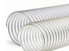
**Structure:** Gaine flexible faite d'une paroi polyuréthane polyéther souple de qualité alimentaire selon la norme CE 1935/2004 et la EU 10/2011 modifiée ainsi que la réglementation FDA-Norme 21 CFR 177.2600 et 178.2010 et antistatique permanent (R<10<sup>8</sup> Ohm), renforcée d'une spirale en inox. INOXX PU 04 FOOD: Paroi 0,4mm. INOXX PU 07 FOOD: Paroi 0,7mm. INOXX PU 14 FOOD: Paroi 1,4mm.
