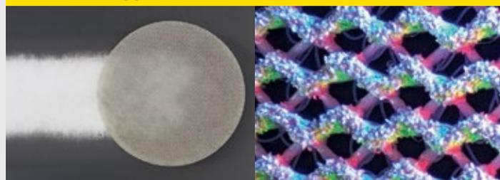
Le support réticulé, constitué d'une fibre polyester, est obtenu grâce à un procédé de fabrication spécifique. Seule la fibre supérieure du réseau est pourvue de grains. Il n'y a aucun grain au dos de l'abrasif qui est lui recouvert de boucles de fixation siafast.
