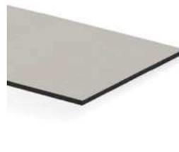
Stratifié haute pression compact pour l'extérieur en qualité standard conformément à la norme EN 438-6:EDS / pour les décors intensifs conformément à la norme EN 438-6:EGS. Composé d'un noyau noir homogène, revêtu d'une laque acrylique décorative sur une ou deux faces. Dans le cas d'une seule face laquée, la contreface sera revêtue d'une résine mélaminée décorative.
