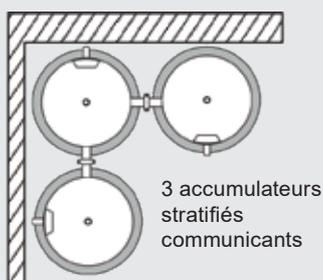
Outre l'installation en série, il est aussi possible de monter les accumulateurs stratifiés en diagonale. Dans ce cas, des joints d'accouplement décalés de 90° sont posés sur l'accumulateur stratifié situé au milieu.
