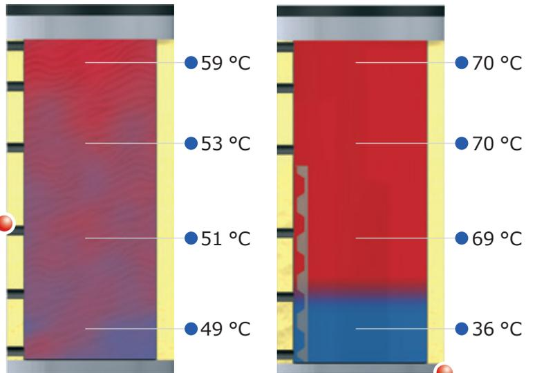
Stratification thermique grâce à la cage de stratification
