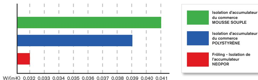
Le Neopor® est la nouvelle génération de l'isolant Styropor®. Le polystyrène expansé est enrichi de particules de graphite qui réfléchissent le rayonnement thermique et réduisent ainsi les déperditions de chaleur.
