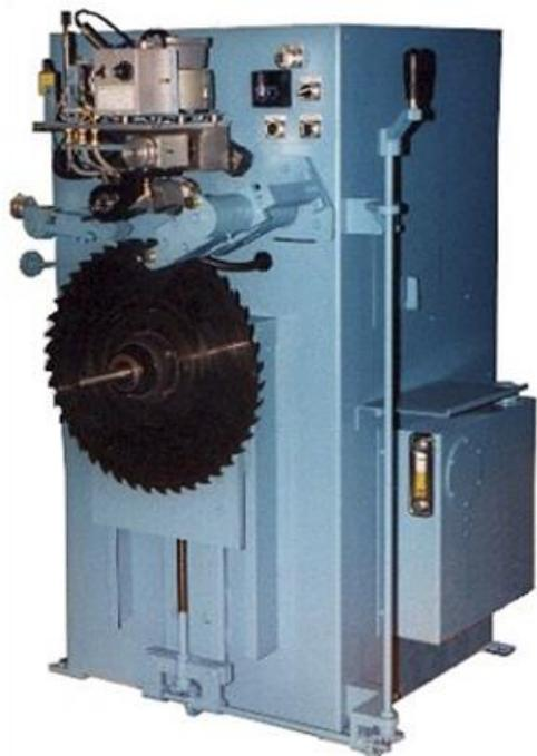
Une Autotip peut être équipée pour pastiller les lames ruban et circulaires. Par exemple, une Autotip seule peut pastiller les lames de 7 bâtis ruban et de 60 lames circulaires. Cela prend juste 5 mn pour passer des lames ruban aux lames circulaires
