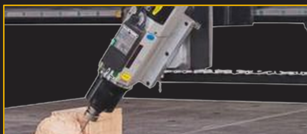
Testa a 4 assi su mandrino per la lavorazione dei bordi e la creazione di alorilievi
